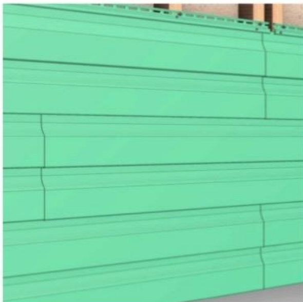
Рис. 24 Смещение стыков панелей сайдинга при стыковке внахлест.
