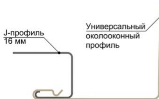
Рис. 17 Соединение универсального околооконного профиля 89/254 мм с J-профилем 16 мм.
