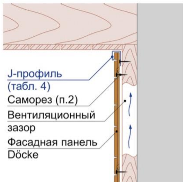
Рис. 23 Примыкание фасадных панелей Döcke к горизонтальной поверхности
