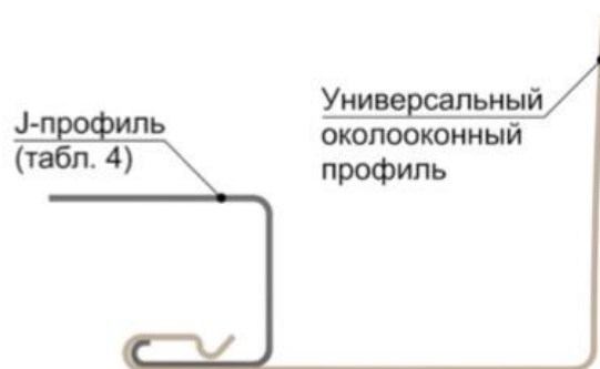
Рис. 12 Соединение универсального околооконного профиля с соответствующим J-профилем (таблица 4).
